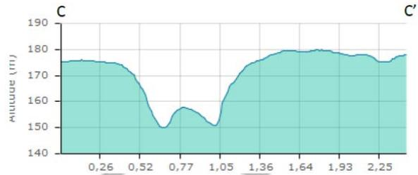
Au sein du massif, la topographie n'est pas homogène. C'est aussi une « contrainte » à prendre en compte, notamment sur la hauteur des éoliennes à mettre en place. L'idée est de travailler sur la hauteur des mâts pour avoir des hauteurs de machines les plus homogènes visuellement. Nous ne mettrons pas d'éoliennes dans les cuvettes.
